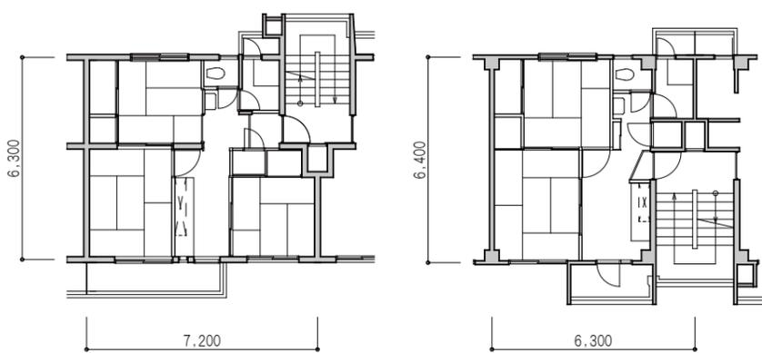
26・27号棟住戸平面図(41.98㎡) 28号棟住戸平面図(35.42㎡)
