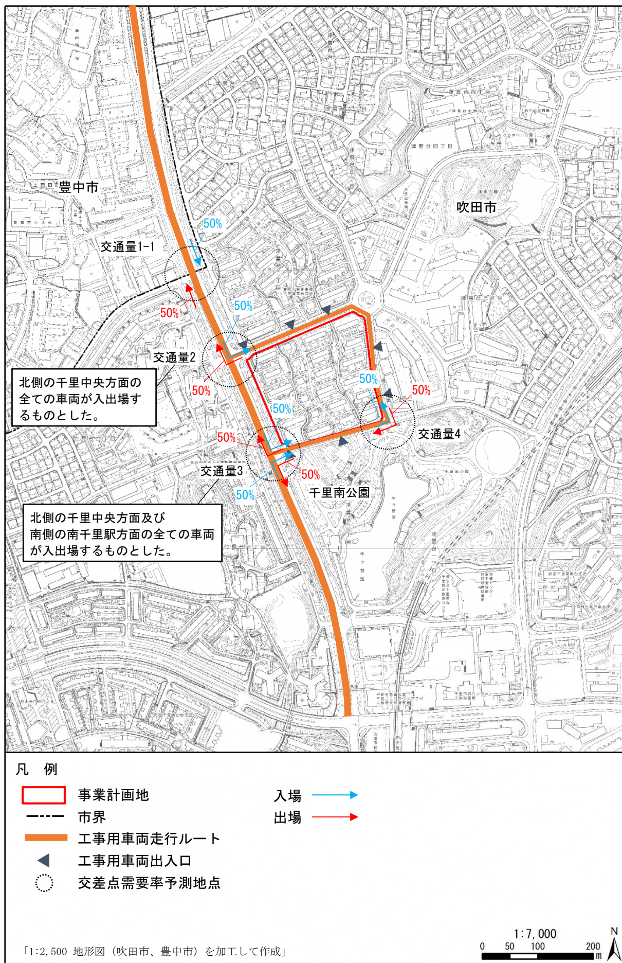
図 1-2-2 工事用車両の方向別割合（交通混雑）
