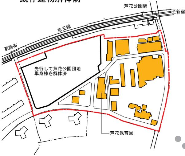
分有・分棟型の特徴を生かして、権利変換を受ける予定の関係権利者を一時に全員地区外仮移転させることなく、3段階に分けて土地の明渡し、既存建物の解体、施設建築物の整備を行い、基盤整備についても施設建築物の進捗に合わせて整備する手法を取り入れています。
