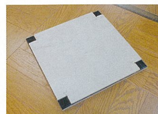
面ファスナーを用いた置敷きフローリング
