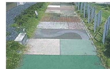
透水性ブロック舗装等の比較試験(八王子試験場)
