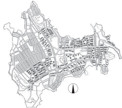
香里 関西の代表的な初期の宅地開発に香里団地がある。昭和37年完成時には東洋一のニュータウンと呼ばれた。現況樹林の保全や擁壁の設置を減らし、豊かな自然を生かした配置で自然派に分類されていた。
