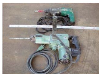
ハンマードリル (上が小、下が大)
