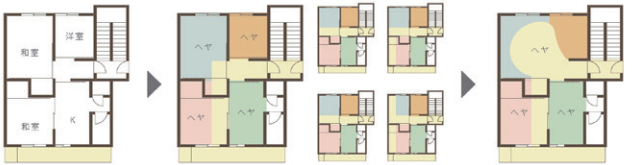
尾崎団地を敷地に設定した名古屋工業大学大学院の「ゴキンジョサイコウ ―住戸をへやに分解し、サ高住化する―」 上：2 階平面図 下：「住戸をへやに分解する」概念図
