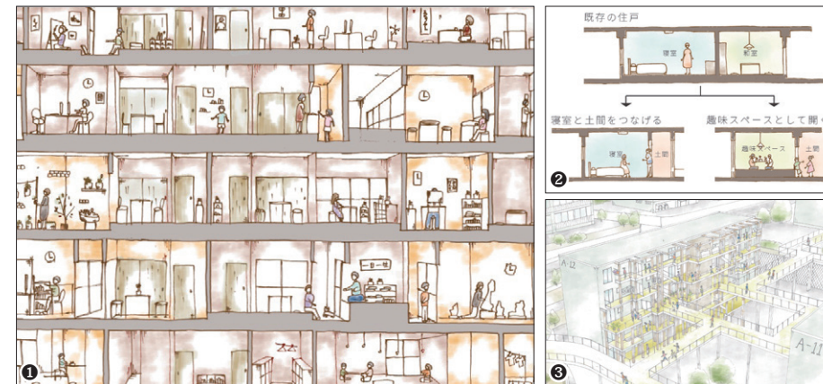
① サ高住を組み込んだ内部のイメージスケッチ ② 構成変更の概念図 ③ バルコニーに住民の趣味が表出
