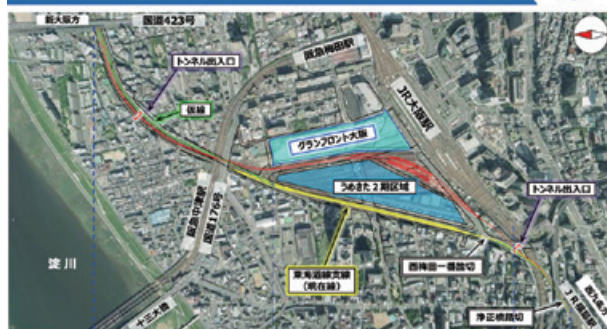
JR東海道線支線地下化・新駅設置事業(工事の概要)
