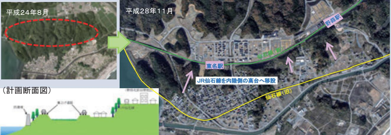
野蒜北部丘陵地区では、仙石線の早期復旧及び集団移転先となる高台宅地の早期完成を目標として、CM方式を活用した基盤整備を進めています。目標達成のためには、高台で発生する大量の土砂をいかに迅速に搬出するかが課題でしたが、URとCMRが相互に連携し、ベルトコンベアを活用して短期間で土砂搬出を完了しました。目標通り、平成27年5月30日には仙石線が全線再開し、平成28年11月に高台宅地をすべて引き渡しました。
