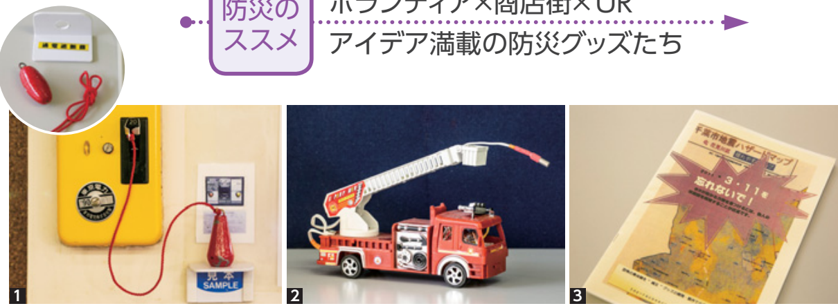
[1] 感震ブレーカー。不安定な形の重しが地震の揺れを感じて下に落ちることで、ブレーカーを切る仕組み [2] 揺れを感じると、大きな音と光を発する装置。発報が作動する揺れの大きさはセンサーの角度で調整でき、自宅の事情(高層階・平屋建ての違いなど)にあわせてことで地震発生時に避難対応などが素早くできます。製作費用は1,000円未満 [3] 小冊子「3・11を忘れないで」を製作し、自ら行っている取り組みを紹介。「防災講座」でも家具の転倒防止などの器具の取り付け方などを体験できる展示コーナーを開設。値段のことや工具の貸し出しなどの相談にも対応します
