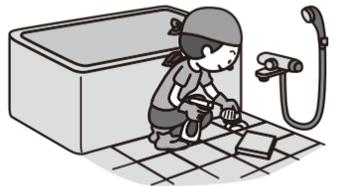
掃除の仕方は、排水口の目皿をはずし、さらにワン(ワン型トラップ)を取り出して、詰まっている髪の毛やゴミを取り除きます。この時に取り除いたゴミ等を絶対に排水口に流さないでください。
