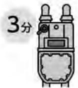
3分間のランプ点滅中に、マイコンメーターが安全確認を行い、異常がない場合は点滅が消えてガスをご使用になれます。3分以上点滅が続くときは、ガス機器の止め忘れがないかを再確認して、やり直してください。
