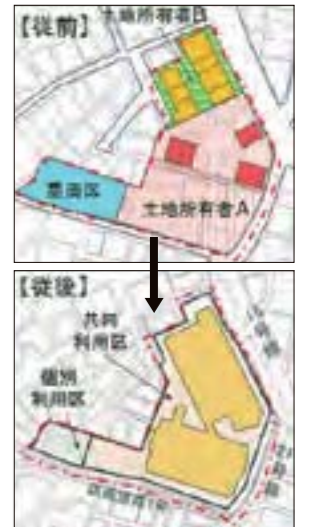
主要生活道路である21号線を道幅4mから6mに、区画道路1号を道幅2mから4mに広げることができた
