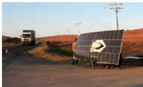
朝日に向けてソーラーパネルを傾け走行用の電力を充電 [サウスアフリカン・ソーラー・チャレンジより]
