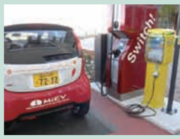
“エコ・ストア”を目指す「イオンレイクタウン(埼玉県越谷市)」に導入された電気自動車(三菱)の高速充電ステーション。
