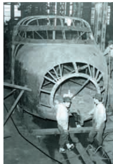
山下さんの起業を促した東海道新幹線0系の先頭構体が製作されている。(1963年)翌年東京オリンピックの開催と同時に、東京-新大阪間を時速200kmで走行し、世界から注目を浴びた。
