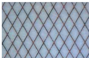
極細配線そのものを印刷し、メッキをつけて通電。電気製品の小型化に寄与。
