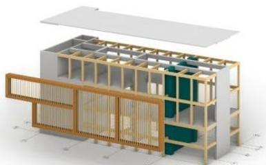
RC造-木造の併用構造フレーム
