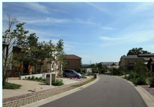
ガーデンシティ舞多間では、緩やかな曲線の道路形態と電線類の地中化により広がりある空間を創出。
