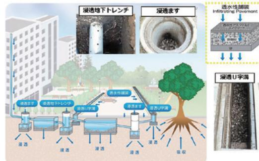
雨水浸透工法の概要
