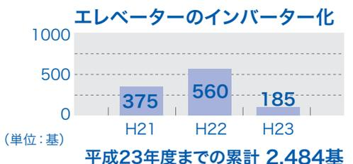
※インバーター制御システム モーターが運転と停止を繰り返す従来の制御方法に比べ、スムーズなモーター制御によりエネルギー効率のロスを低減します。
