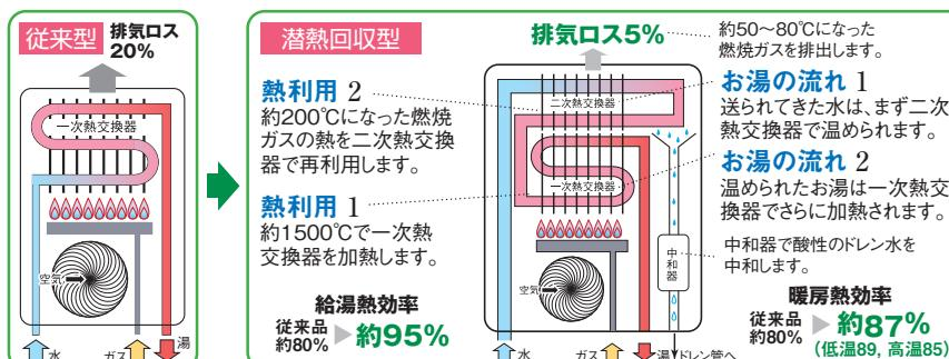
潜熱回収型給湯暖房機の仕組
