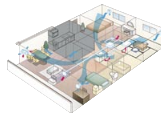
常時小風量換気システム 新鮮な空気を 24 時間取り入れ 住戸内の換気を行います
