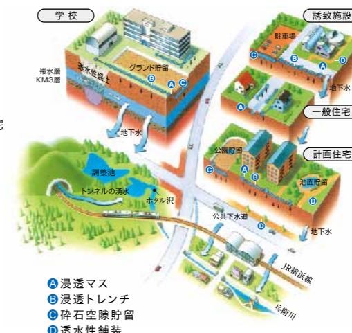
水循環再生システムの構築による環境保全の取り組み (八王子みなみ野シティ)
