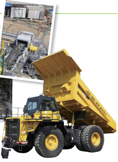
山を最大80mほど切り崩し、高台に住宅地を造る(上)。切り出された岩石と土砂は、直径30cm以下に砕かれ、ベルトコンベヤーで気仙川対岸の旧市街地にまで運ばれる(右上と左)。現場では背丈より大きな車輪を持つ50t積みの巨大なダンパーが活躍する(右)
