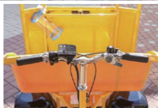
「八王子市シルバーふらっと相談室館ヶ丘」の前が団地タクシーの拠点。登録者からの要請を受けて、ここから出発する(上)。団地タクシーは前2輪、後ろ1輪の3輪車で、荷物置きも備えている(右下)。運転方法は基本的に自転車と同じ、変速機も備えている(左下)
