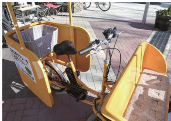
「八王子市シルバーふらっと相談室館ヶ丘」の前が団地タクシーの拠点。登録者からの要請を受けて、ここから出発する(上)。団地タクシーは前2輪、後ろ1輪の3輪車で、荷物置きも備えている(右下)。運転方法は基本的に自転車と同じ、変速機も備えている(左下)
