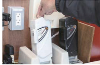
電動アシスト用のバッテリーの充電は団地入り口のバス待合所の屋上に設置された太陽光発電パネルの電力で行う(上の2枚の写真)。こぎ手のサドルの下にあるバッテリーを外して充電しておく(下の2枚の写真)
