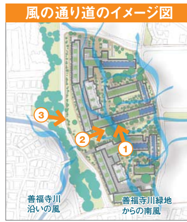
配置計画を立案する際、風洞実験をして風の流れを確認した
