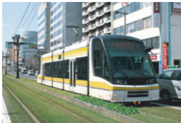
芝生化された市電軌道敷 最新の超低床電車(連節車)が軽快に走り抜ける 高見馬場
