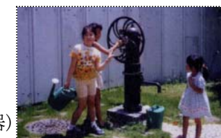
手押しポンプ(雨水利用)
